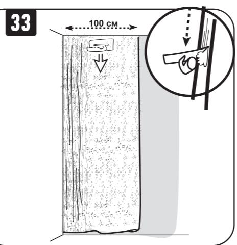
Очистите кромку инструмента ветошью и соскребите движением сверху вниз следующую полосу.
