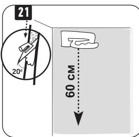
Сильно нажимая на шпатель, нанесите в левом верхнем углу от потолка вниз мазок длиной 60 см.
