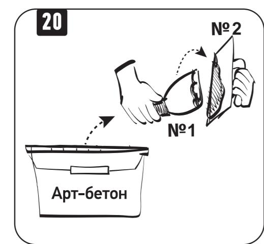
Положите смесь из большого ведра с помощью ШПАТЕЛЯ №1 на кромку ШПАТЕЛЯ №2, как на рисунке.
