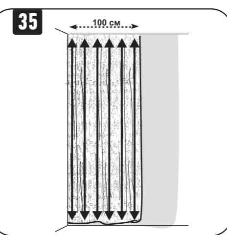
Очистите инструмент и приложите его плоскостью к поверхности. Затирайте рисунок движениями вверх-вниз на всю высоту стены, объединяя и выравнивая рисунок, до появления небольшого глянца.
