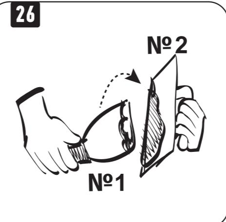
Положите смесь из ВЕДРА №3 с помощью ШПАТЕЛЯ №1 на кромку ШПАТЕЛЯ №2, как на рисунке.
