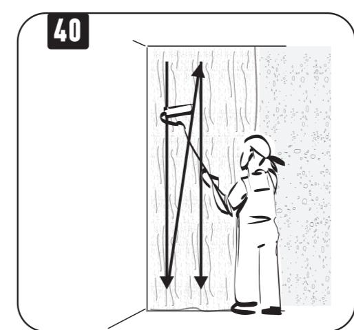
Приложите валик в верхний левый угол и нанесите материал на стену в виде буквы V шириной 50 см на всю высоту стены
