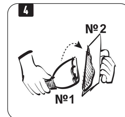
Прижмите валик к стене в левом верхнем углу и нанесите грунтовку от пола и обратно в форме буквы V.
